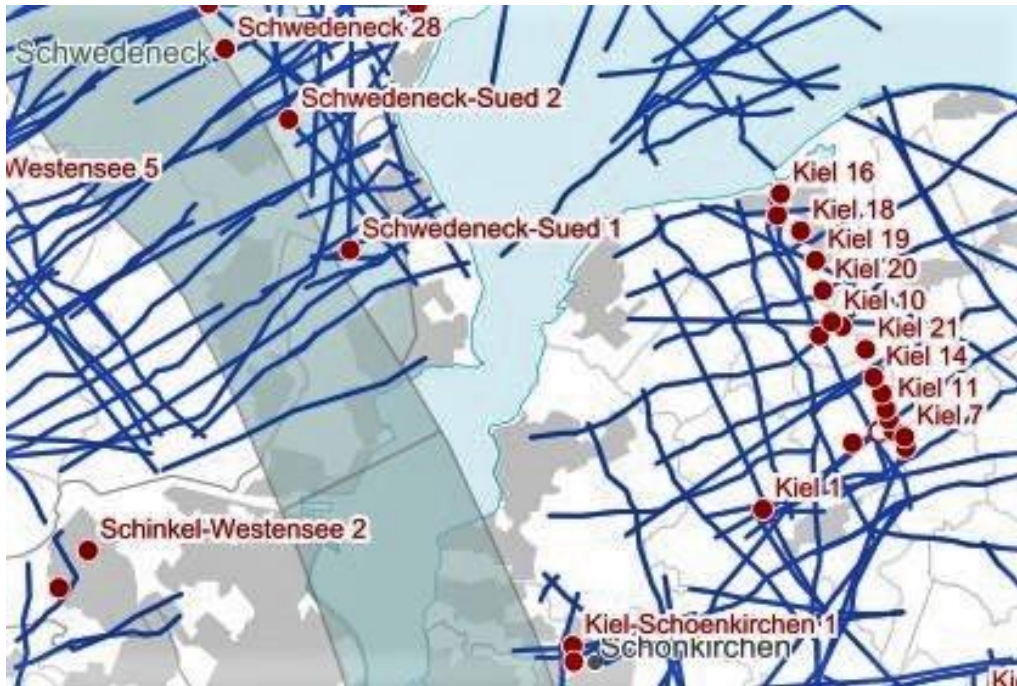
Abb. 3 Salzstruktur, seismische Profile und Bohrungen im Bereich der Kieler Förde (Geotls, Agemar 2014)
