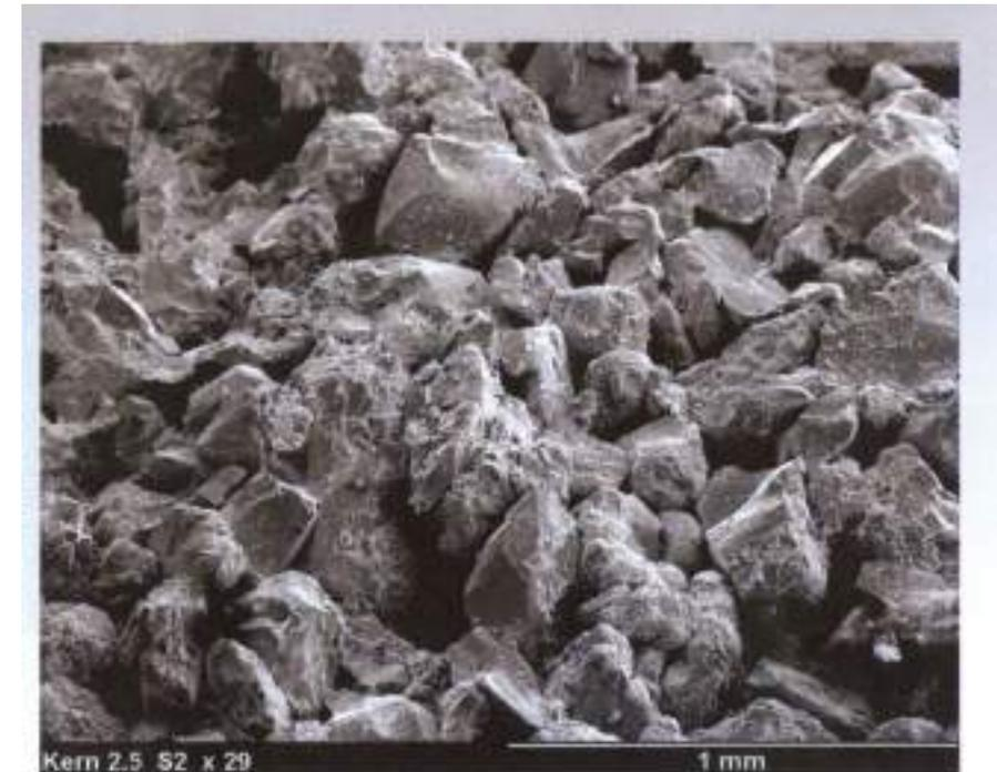
REM-Bild der Oberfläche eines Bentheimer Sandsteins.
