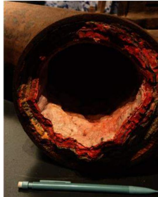
Wartungsarbeiten zur Reinigung der Rohre müssen daher bei festgestellter Radioaktivität unter Strahlenschutzbedingungen erfolgen, ebenso die Entsorgung der Ablagerungen. Dies ist industrieller Standard.
