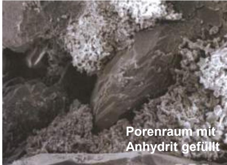
A) der Porenraum des Sandsteins kann durch Mineralausfällungen gefüllt sein (Anhydritzementation) → kaum oder gar nicht nutzbarer Porenraum.
